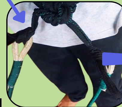
Cinturón sujeto a ambos cabos (se coloca cuando ya están sujetos a la palmera).
