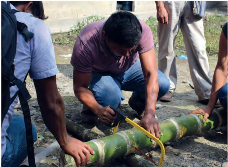
Figura 73. Corte, despunte y calibrado de la caña.
