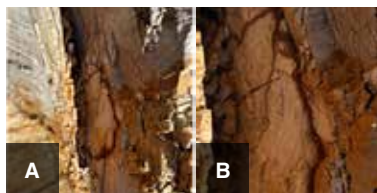
Figura 5. A. Sección transversal de árbol muerto con proporción de albura y duramen. B. Acercamiento de la sección aprovechable (duramen).
