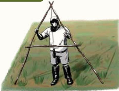
**Paso 1:** Colocar una pata del nivel en cualquier punto del terreno a plantar.
